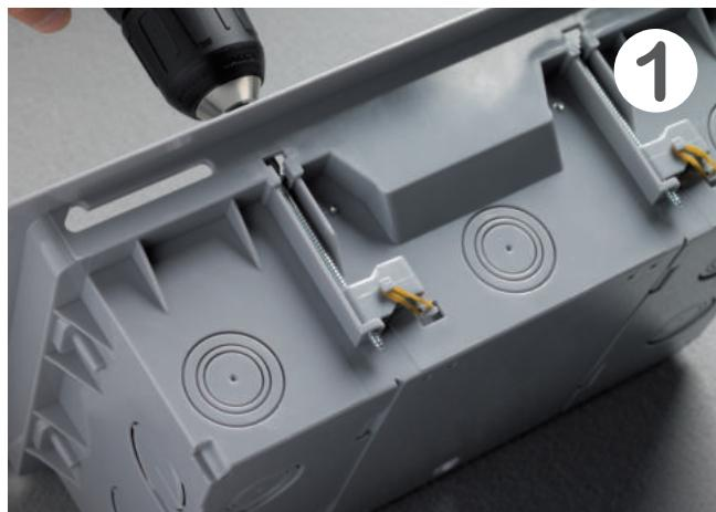
Si possono montare su pavimenti flottanti con mattonelle di spessore da 20 a 60 mm. Il sistema esclusivo di ritorno dei piedini di tenuta, mediante un elastico, permette un agevole montaggio e smontaggio della scatola. Esempio (1,2,3) fasi di serraggio dei piedini di trattenuta.
