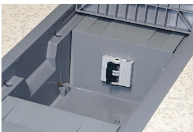
È stata realizzata una mostrina per l'alloggiamento interno di 2/4 interruttori modulari da 17,5 mm; il montaggio/smontaggio avviene tramite una barretta DIN applicata con viti direttamente sul fondo della mostrina, agevolandone il montaggio.
