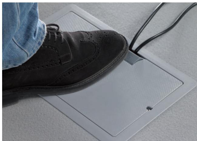
Per non danneggiare pericolosamente i cavi contenuti all'interno della scatola a filo pavimento, la forma interna ed esterna della zona di uscita cavi è smussata, in modo tale da facilitare la curvatura dei cavi al suo interno.
