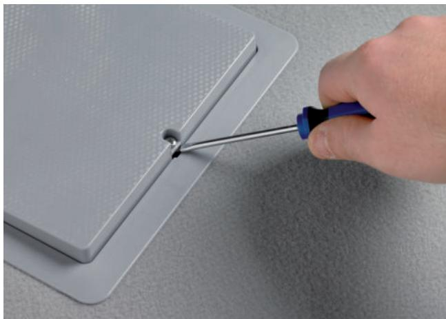
Un sistema esclusivo di chiusura del coperchio, mediante una vite speciale con filettatura metrica, che si impegna in una boccola in ottone assicurata alla base, evita sgradevoli manomissioni o modifiche non volute.
