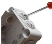
Le caratteristiche tecniche dell'entrata stagna ne permettono il taglio anche tramite cacciavite o qualsiasi utensile appuntito. Posizionare il cacciavite sul gradino, effettuare una pressione fino a provocarne la rottura.
