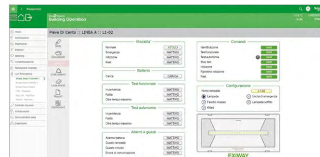
La Control Unit ha protocollo di comunicazione **Modbus TCP-IP** in modalità **Server**, che ne permette l'integrazione nei sistemi di Building Automation. In particolare, parlando della piattaforma EcoStruxure di Schneider Electric, è disponibile un widget per facilitare il lavoro del System Integrator nell'integrazione del sistema EcoStruxure Building Operation.
